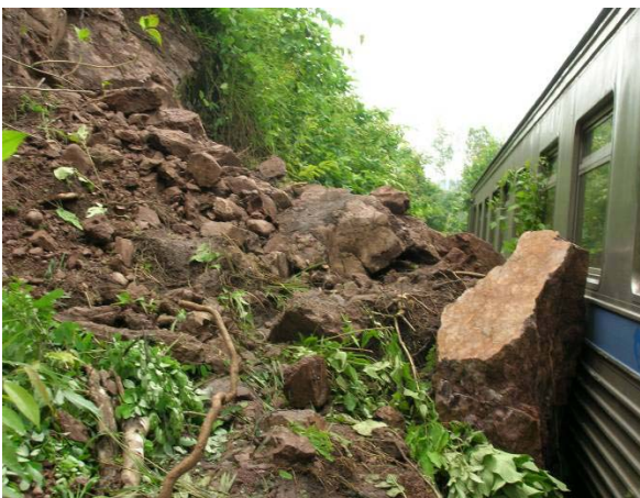
รูปที่ 2.4 สภาพความเสียหายที่เกิดขึ้นเนื่องจากเศษหินและดินไหลชนขบวนรถไฟ ปี พ.ศ. 2549
