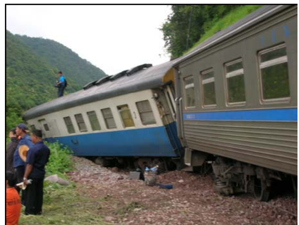
รูปที่ 2.4 สภาพความเสียหายที่เกิดขึ้นเนื่องจากเศษหินและดินไหลชนขบวนรถไฟ ปี พ.ศ. 2549
