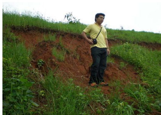
ดินมีการทรุดตัวลงจากระดับเดิมประมาณ 0.8 เมตร
