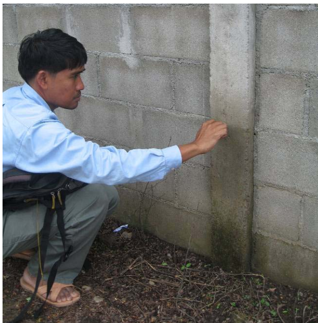
รูปที่ 3.6 ระดับน้ำป่าไหลหลาก ปี พ.ศ. 2548 บริเวณบ้านห้วยทราย
