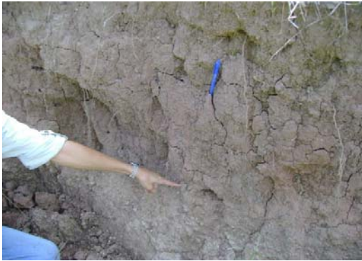
รูปที่ 2.4 ลักษณะชั้นดินล่างซึ่งเป็นชั้นดินลูกรังที่มีการยึดเกาะไม่ค่อยดี
