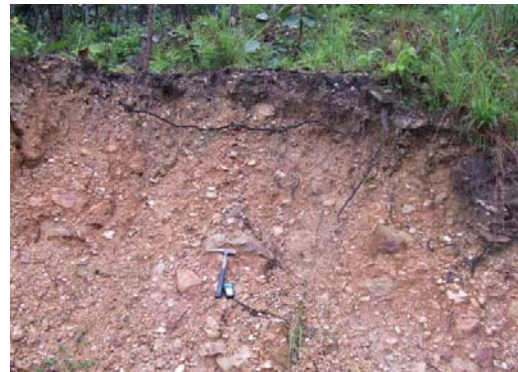
รูปที่ 2.7 ลักษณะชั้นตะกอนลานหินพังเป็นดินปนกรวด ที่มีเหลี่ยมคมสูง
