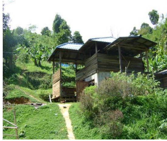
รูปที่ 3.2 บ้านเรือนที่เสี่ยงภัยดินถล่มในพื้นที่ หมู่ที่ 3 บ้านต้นแดง ตั้งอยู่บนพื้นที่ลาดชัน ชั้นดินหนาและมีร่องรอยดินถล่มในอดีต
